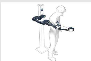
© Deledda Robot d'assistance des membres supérieurs de type bras exosquelette
