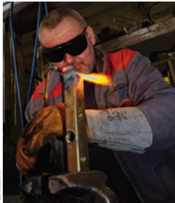
Figure 9. Opération de soudage à la flamme
